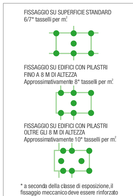
7. Esempi di fissaggio meccanico su latero-cemento
