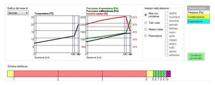
Il grafico mostra come le curve di pressione di vapore (curva nera) e la curva di pressione di vapore di saturazione (curva verde) non si intersecano. Per semplicità è stato inserito il diagramma del mese più critico che risulta essere gennaio.
