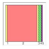
La riduzione della **trasmittanza termica** e quindi delle dispersioni, è stata del **56%**, un valore decisamente positivo avendo utilizzato solo **4cm** di isolamento. Lo **sfasamento termico** è passato dalle 16h 30' a **18h e 33'** con un guadagno di circa 2ore e la trasmittanza termica periodica è diminuita fino ad un valore di 0,014W/mqK.
