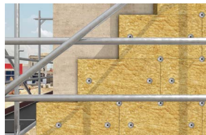
Fissaggio di pannelli in lana minerale su calcestruzzo
