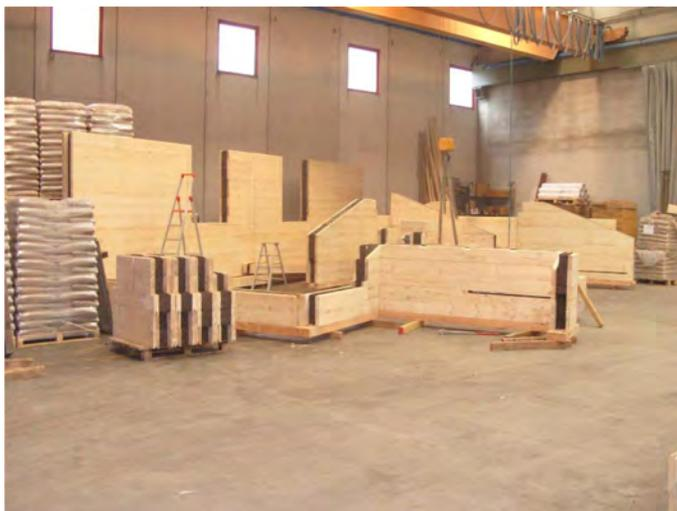
Le travi che compongono le pareti dell'edificio vengono assemblate e numerate presso il nostro stabilimento; di seguito viene redatto lo schema di montaggio.
